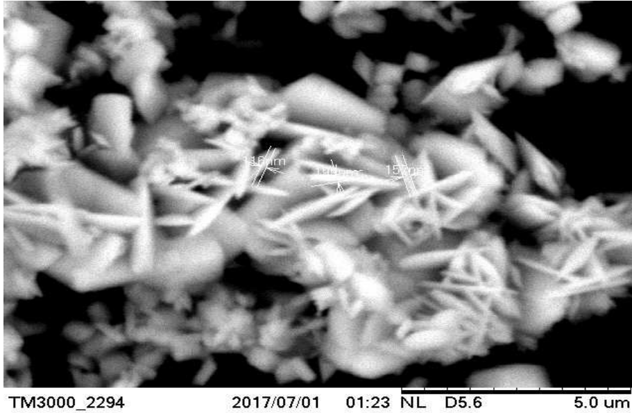
Şəkil 6. Sürmə(III)oksidin ( \text{Sb}_2\text{O}_3 ) mikrofotofəkilli.
